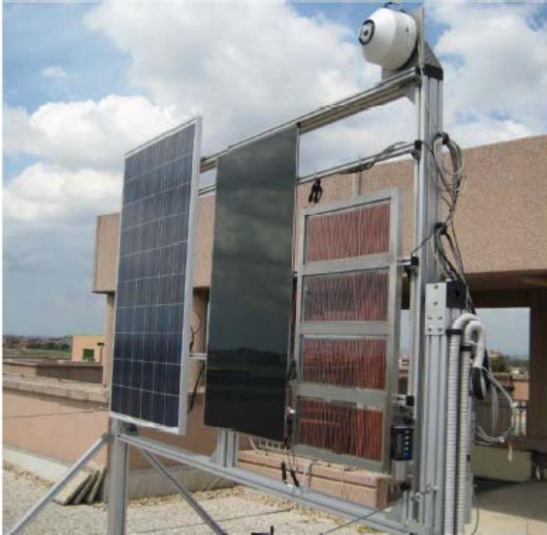
Nel periodo Agosto – Ottobre 2011 è stato effettuato un test di confronto delle tre tecnologie, silicio **cristallino**, silicio **amorfo** e **DSC** in configurazione Verticale - SUD per individuare se esistessero sostanziali differenze di prestazione.
